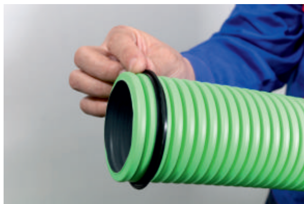
2) Do 2. nebo 3. drážky nasadíme těsnící kroužek.
